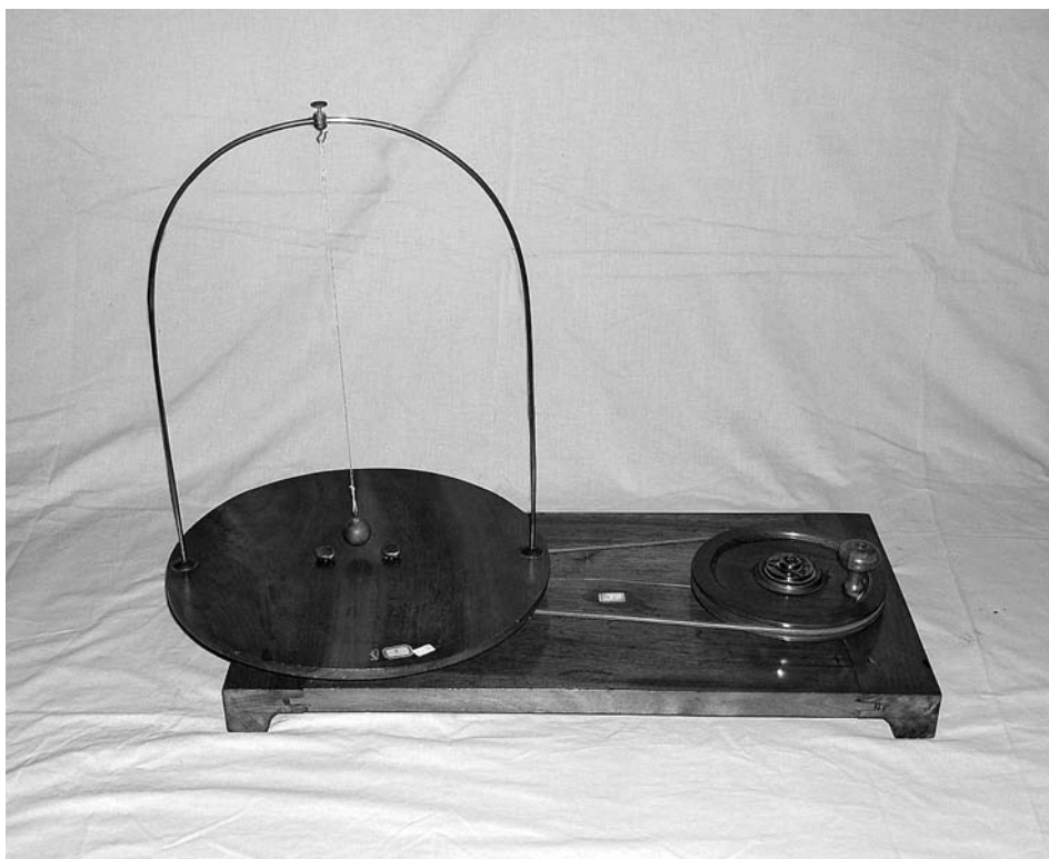
Fig. 11 - Apparecchio di rotazione. Noce nazionale e ottone lunghezza x larghezza x altezza: 600 x 300 x 500 mm.
