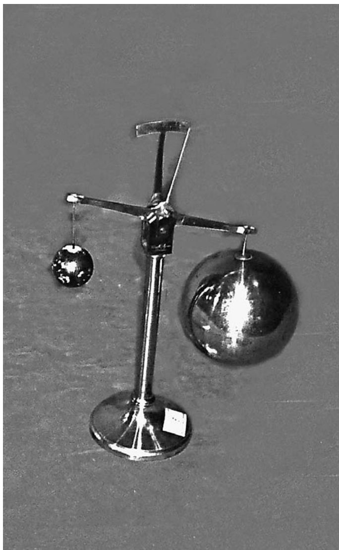
Fig. 22 - Baroscopio Ottone, ferro 260 x 200 mm. Ø sfere: 100, 40 mm.
