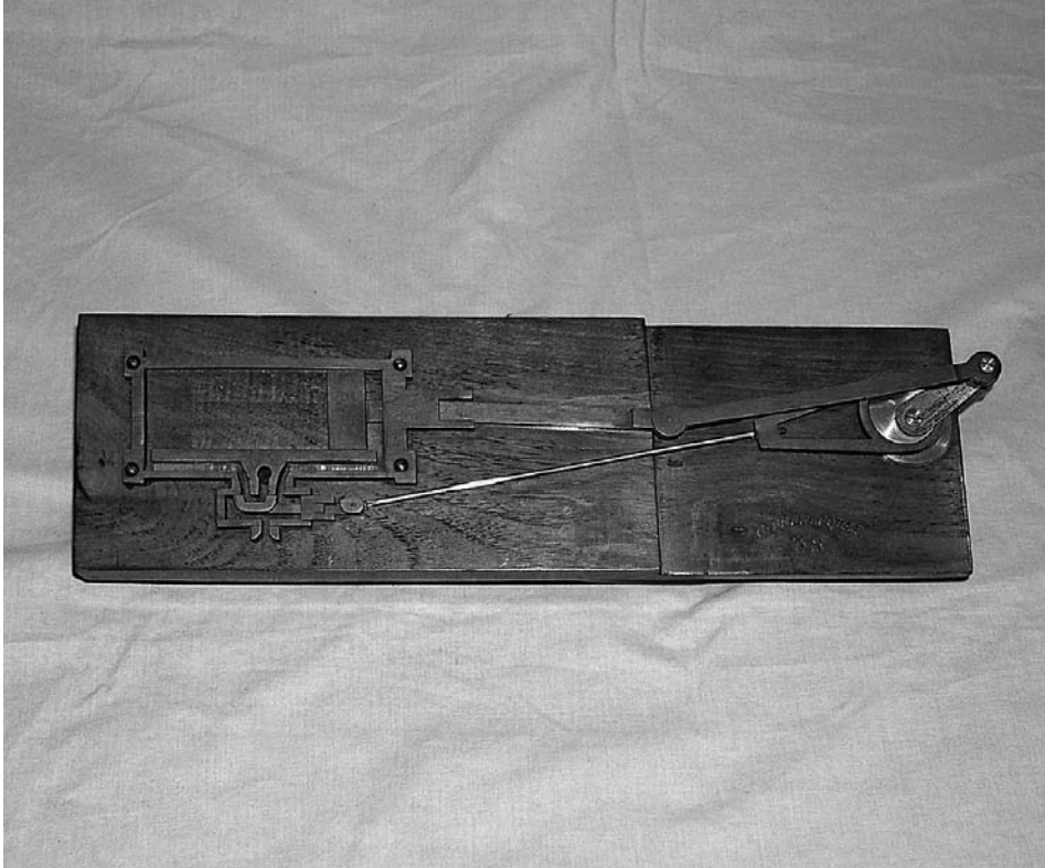
Fig. 25 - Modello di pistone a vapore. Legno, ottone 350 x 100 x 50 mm.
